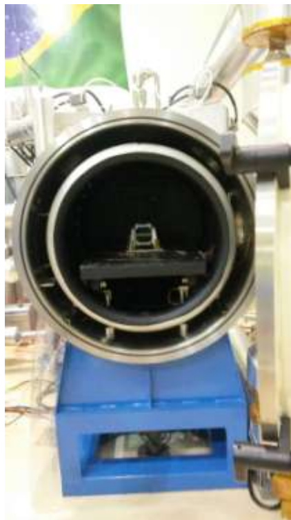
Figura 8: Realização do teste de termo-vácuo, no NANOSATC-BR1, realizado na sala limpa (100.000) do LIT.
